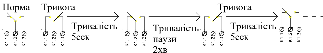
Рисунок 2.3.7 – Послідовність переключень контактів реле К1 в режимі «тривога»
