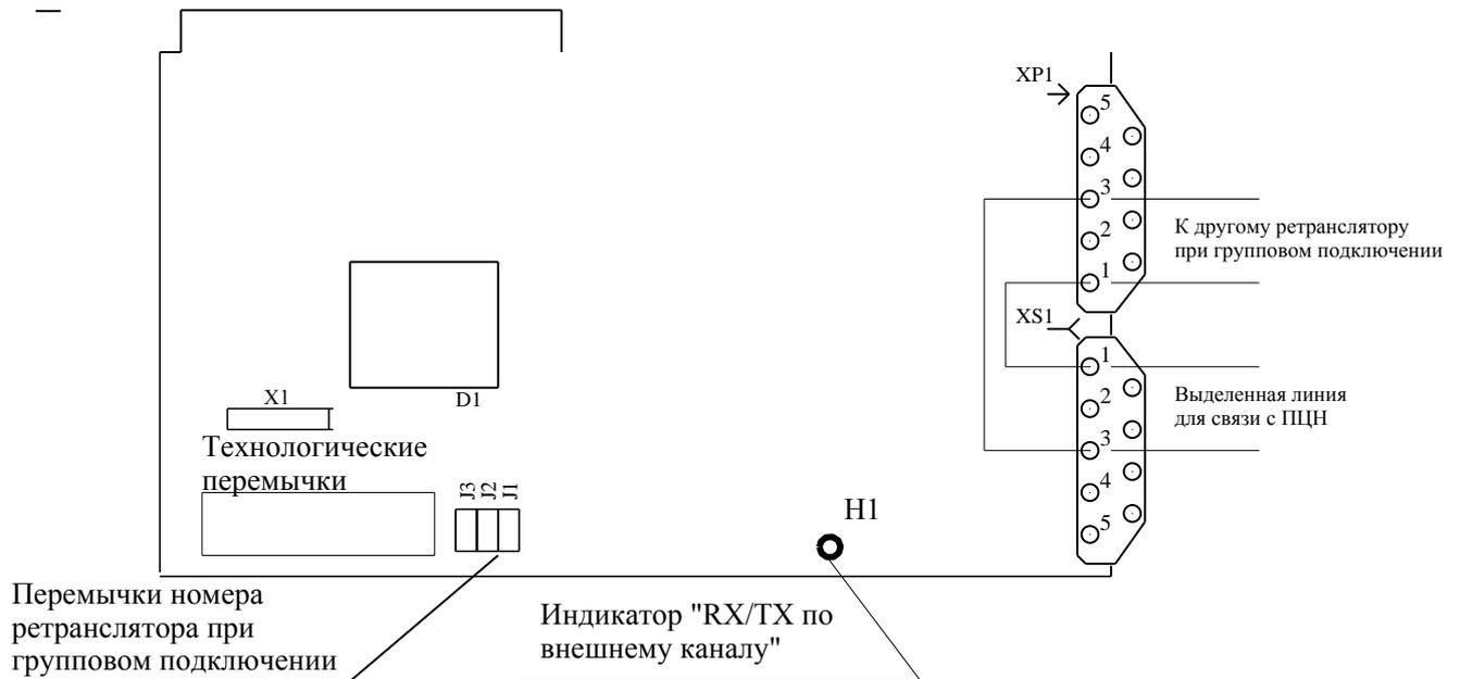
Рисунок Г.1 – Расположение основных элементов устройства управления УУ-18К
